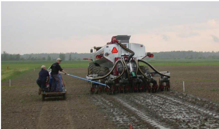
L'agriculture durable passe par l'acceptabilité sociale. À ce chapitre, la réduction des odeurs est une priorité. L'IRDA mesure ici les concentrations de gaz et d'odeurs résultant d'opérations d'épandage.
