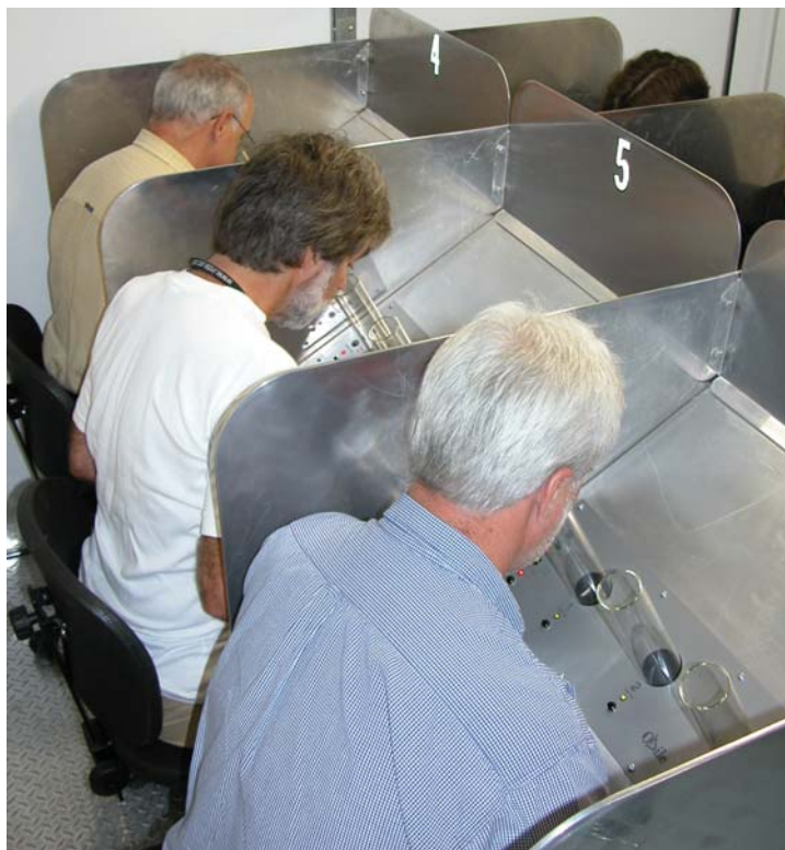
L'olfactomètre a l'avantage de permettre à l'équipe de l'IRDA d'évaluer ses technologies et projets de recherche visant à diminuer les odeurs. L'évaluation est réalisée par des gens formés qui respectent un protocole établi.
