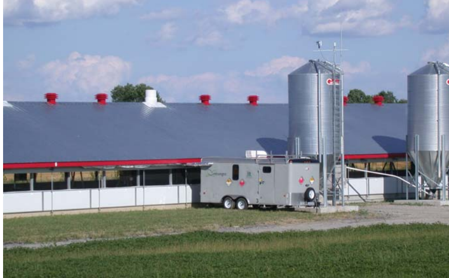
Grâce au laboratoire mobile Mesanges MD III, l'IRDA peut évaluer la qualité de l'air dans un bâtiment porcin.
